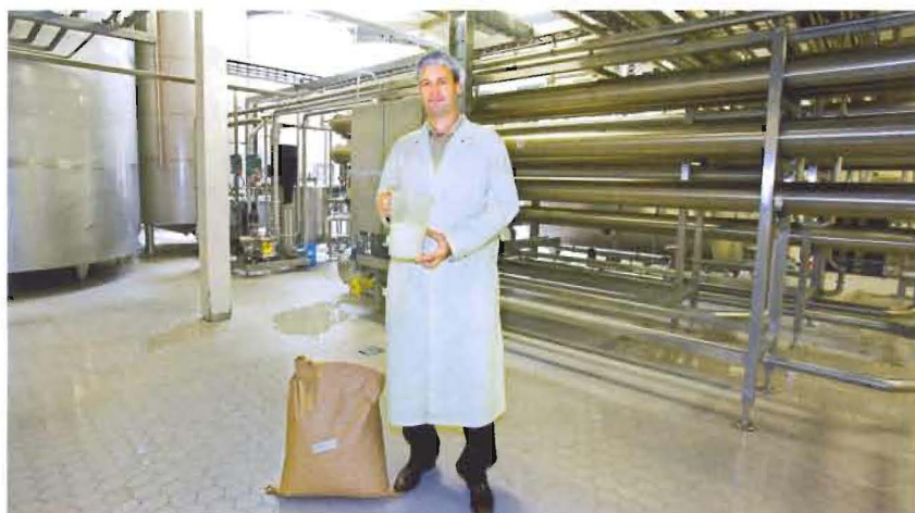
Joost van Dijk met de eerste zak wei-eiwitconcentraat van geitenmelk voor de osmose-installatie. De wei wordt hierin geconcentreerd tot 20%. Het verder drogen gebeurt extern.
